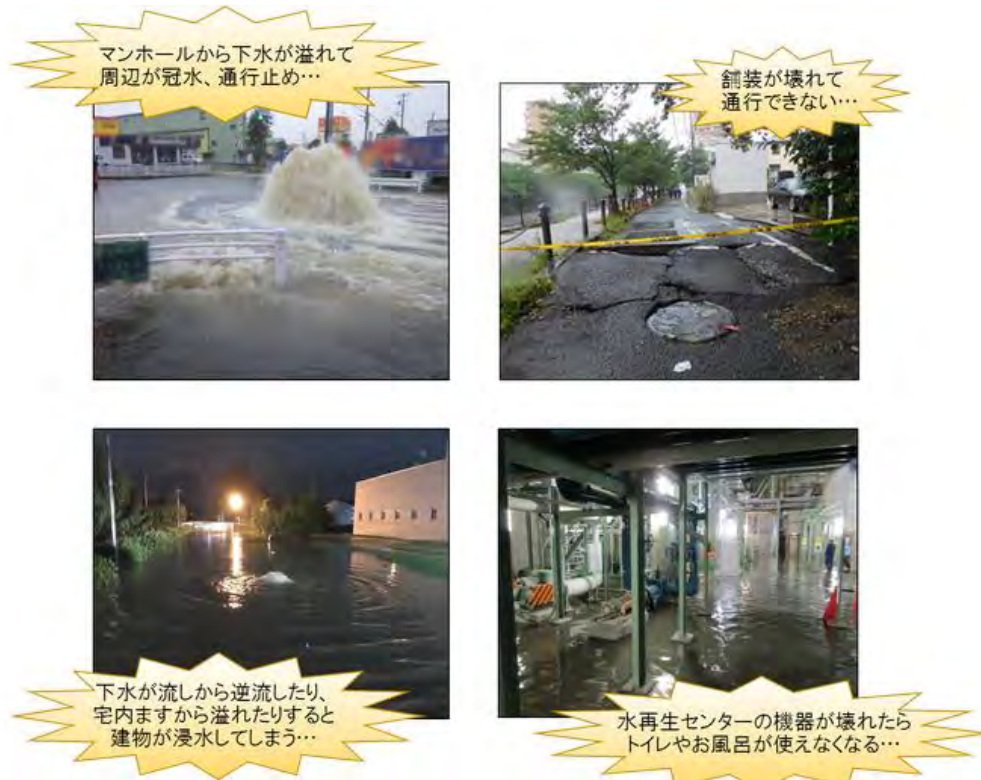
写真 3-9 雨天時浸入水による影響例
