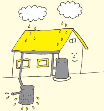
・ 大雨の時、下水道に流れる水を減らすことができます。断水時、トイレに流す水に使えます。
